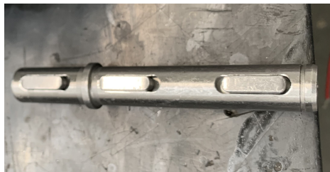
Figura 4.15: Veio e chavetas do redutor.
