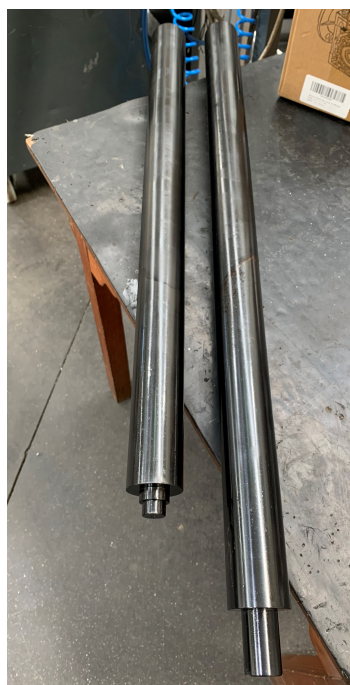
(b) Rolos de aço com tratamento de oxidação a negro.
