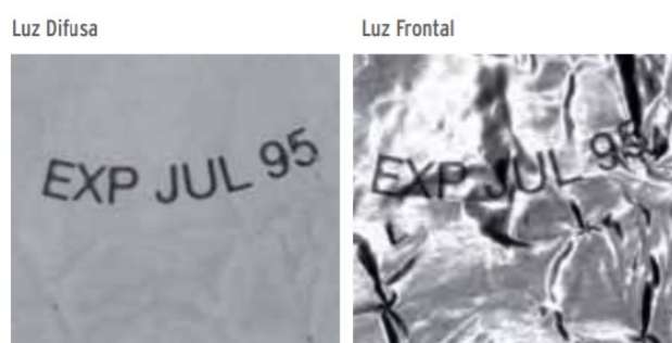
Figura 2.15: Comparação entre luz difusa e luz frontal [17].
